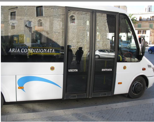
Fig. 1: il marciapiede è più basso della porta di accesso del bus
