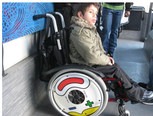
Fig. 14: assenza della cintura di sicurezza.
